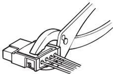
请确定外罩与接头接插件之间无空隙。
