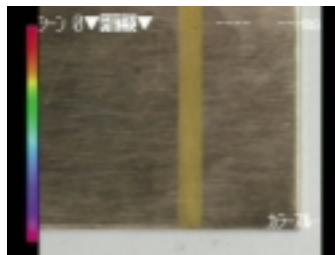
原图像 用边缘检测功能检查铜板上的粘接剂涂布量(宽)。
